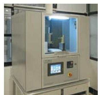
Испытательная линия для проверки работы ламп при разных режимах электропитания (так называемая «aging line»).
