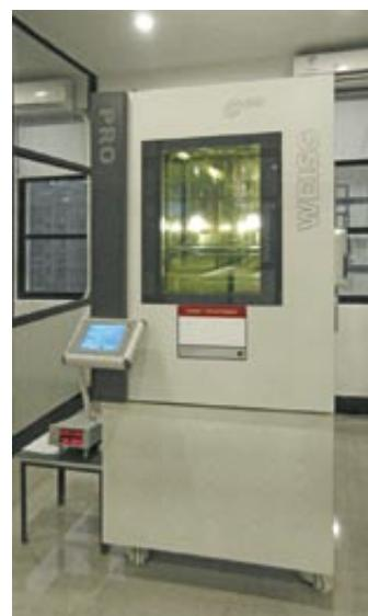
**Слева.** Камера для испытания ламп в разных климатических условиях (до -80°C и 100% влажности).
