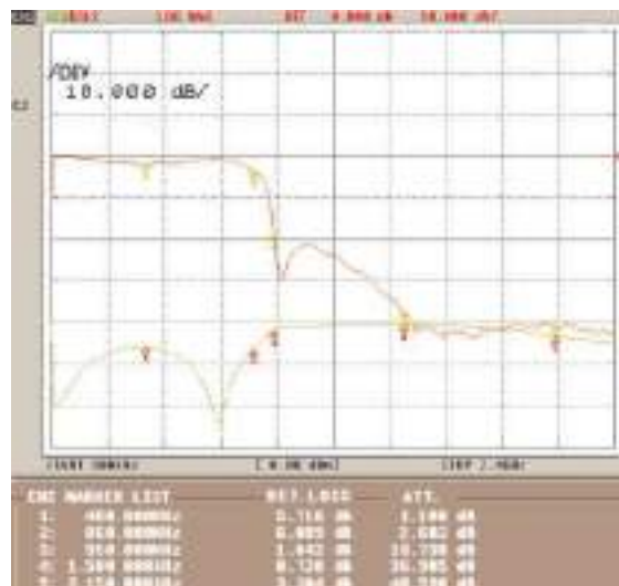
Tap TV A/F response and return loss Tap TV A/F потери на выходе и возвратные Respuesta y pérdidas retorno de la toma TV A/F
