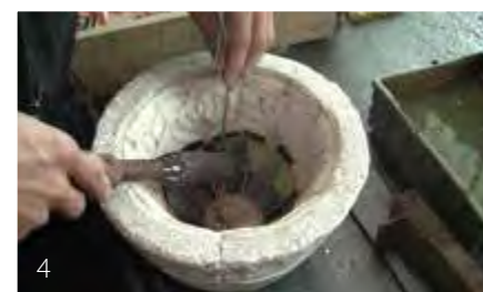
4 Медь оплавляют и собирают витраж в стекловолоконной форме.
