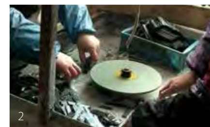
2 Каждый кусочек обрабатывают вручную, придавая максимальную точность контурам.
