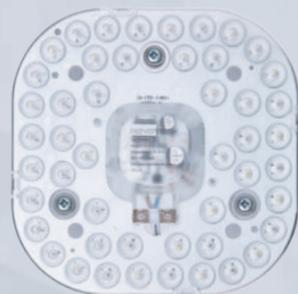
Для улучшения характеристик на текущую плату установлены светодиоды нового поколения мощностью 1 Вт, взамен светодиодов прошлого поколения 0,5Вт. Таким образом, светодиоды
